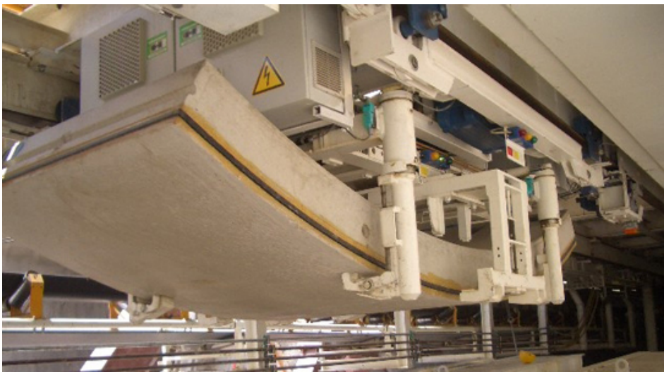
Detalle carga de dovela
